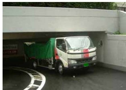
【ビル地下駐車場入口の高さにより減載しないと貨物車が駐車場に入れない事例】
