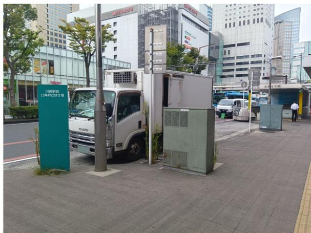
図 3-60 歩道の一部切り込んで荷さばきスペースを確保した事例（川崎市）
